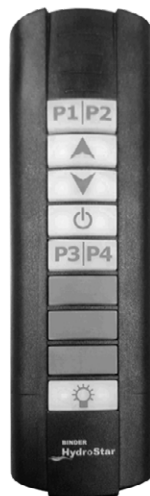
ПУЛЬТ ДИСТАНЦІЙНОГО КЕРУВАННЯ З КОЕФІЦІЄНТОМ ЗАХИСТУ IP67
